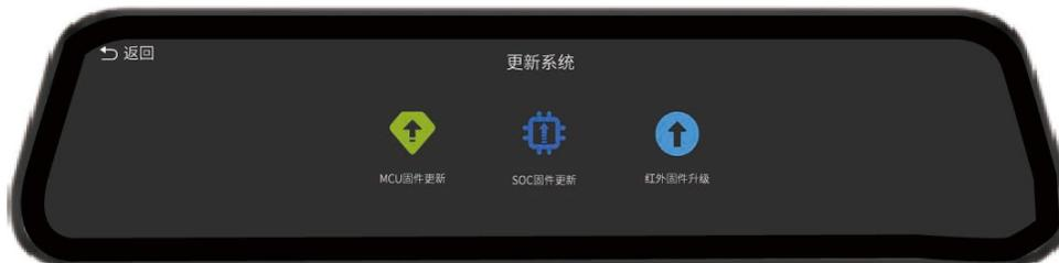
5、MCU固件升级：点击MCU固件更新，显示“MCU准备重启...”画面，MCU重启进入boot阶段。第一次重启后显示进度条画面，并显示“请勿关机，MCU固件正在更新...”，达到100%时显示“MCU准备重启...” MCU重启进入应用层。第二次重启完成后，进入本机信息查看当前MCU版本是否符合。
