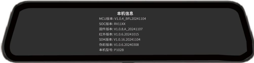
6、SOC固件升级：点击SOC固件更新，显示SOC固件升级界面，“在升级过程中，请勿关机”。当更新完成时，进度条会显示达到100%状态，并显示“更新成功，准备重启设备...”字条。更新完成后，点击本机信息，查看固件版本是否对应当前SD卡所升级的版本。
