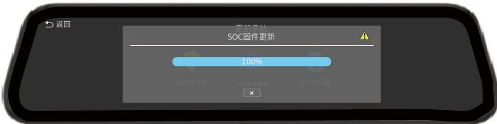
7、红外固件升级：点击红外固件更新，显示红外固件升级界面，可选择当前更新固件为“红外固件”更新以及“伪彩固件更新”。升级过程中显示“请勿关机，红外摄像头固件正在更新...”。当更新完成时，进度条会显示达到100%状态，并显示“更新成功，准备重启设备...”字条。更新完成后，点击本机信息，查看红外版本是否对应当前SD卡升级的版本。
