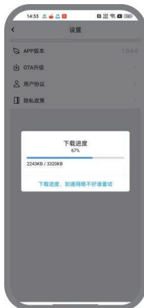
3、固件下载成功后，选择“OTA升级”，自动跳转到WiFi界面，重新选择主机WiFi连接，连接成功后，返回到设置界面，APP会自动上传到主机内存卡里面，自动升级，升级时间为60秒左右。如图所示：
